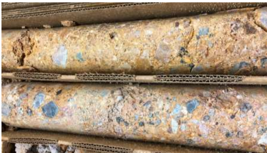
Abbildung 3. Bohrloch ML20-149CT CIZ-Diatrem-Brekzie (6,8 m @ 4 g/t Au & 1,2 g/t Ag)
