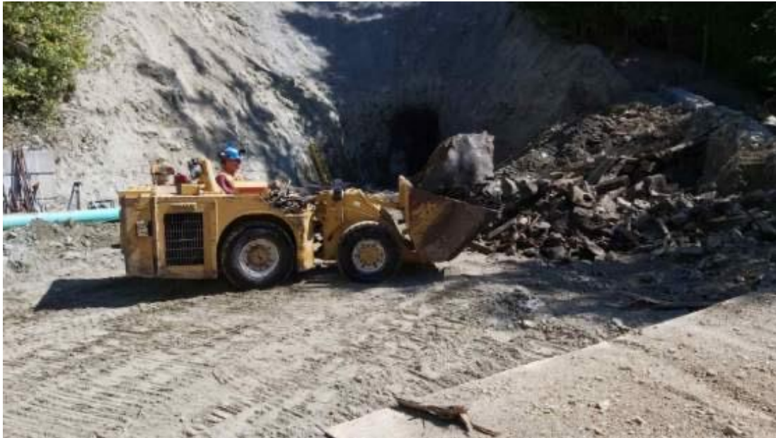
Foto des Scooptram-Laders beim Transport eines großen Felsbrockens.
