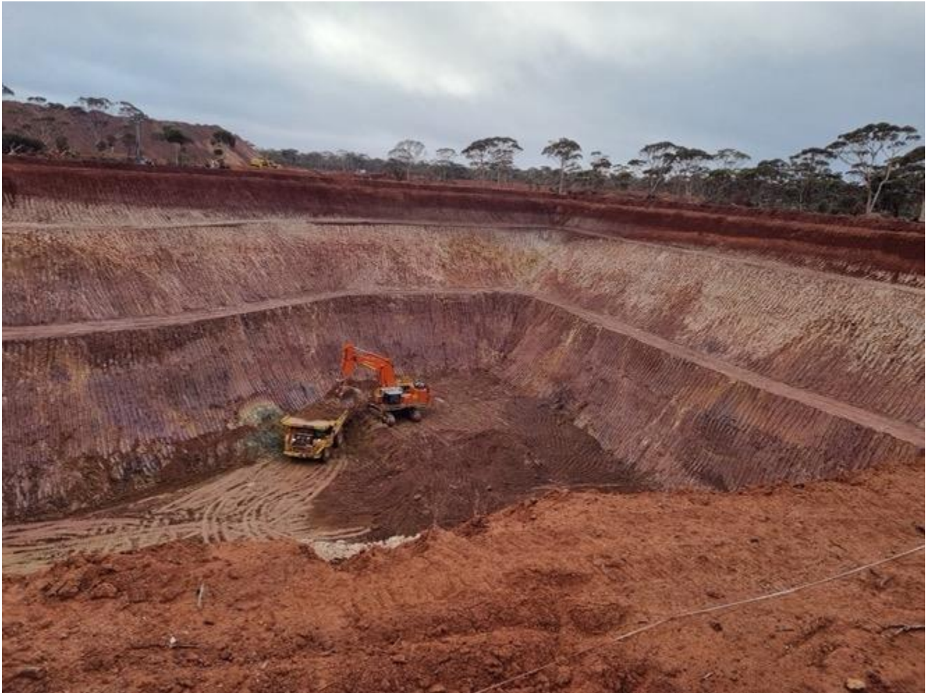
Abbildung 3: Aquarius Mine Kastenschnitt
