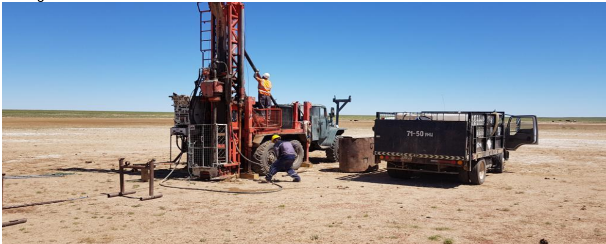
Abbildung 1: Diamant-RC-Bohrgerät in L1 auf Baavhai Uul.
