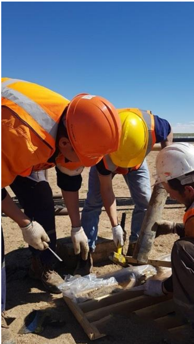
Abbildung 5: Entnahme von Bohrkernproben in Baavhai Uul
