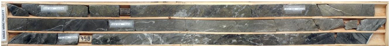
Bildtafel 1: Kernkiste mit dem vererzten Hauptabschnitt in Bohrung EM-14-001 von 354,6 bis 359,1 m Bohrtiefe, der reichlich Pyrit sowie kleine weiße Eisenkarbonat-Gänge zeigt.
