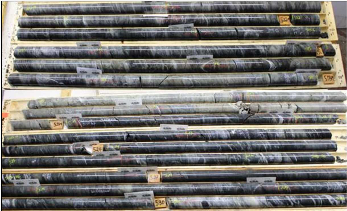
Abbildung 2: Bohrloch GC21-04 zeigt den Huston-Balmer-Kontakt bei 521,1 m (beschriftet auf dem Kern in der Nähe der Mitte des Fotos). Im Huston-Gestein tritt eine intensive Serizit-Alteration auf, während im Balmer-Gestein eine intensive Karbonat-Aderung/-Alteration zur Unterscheidung des Kontakts beiträgt.
