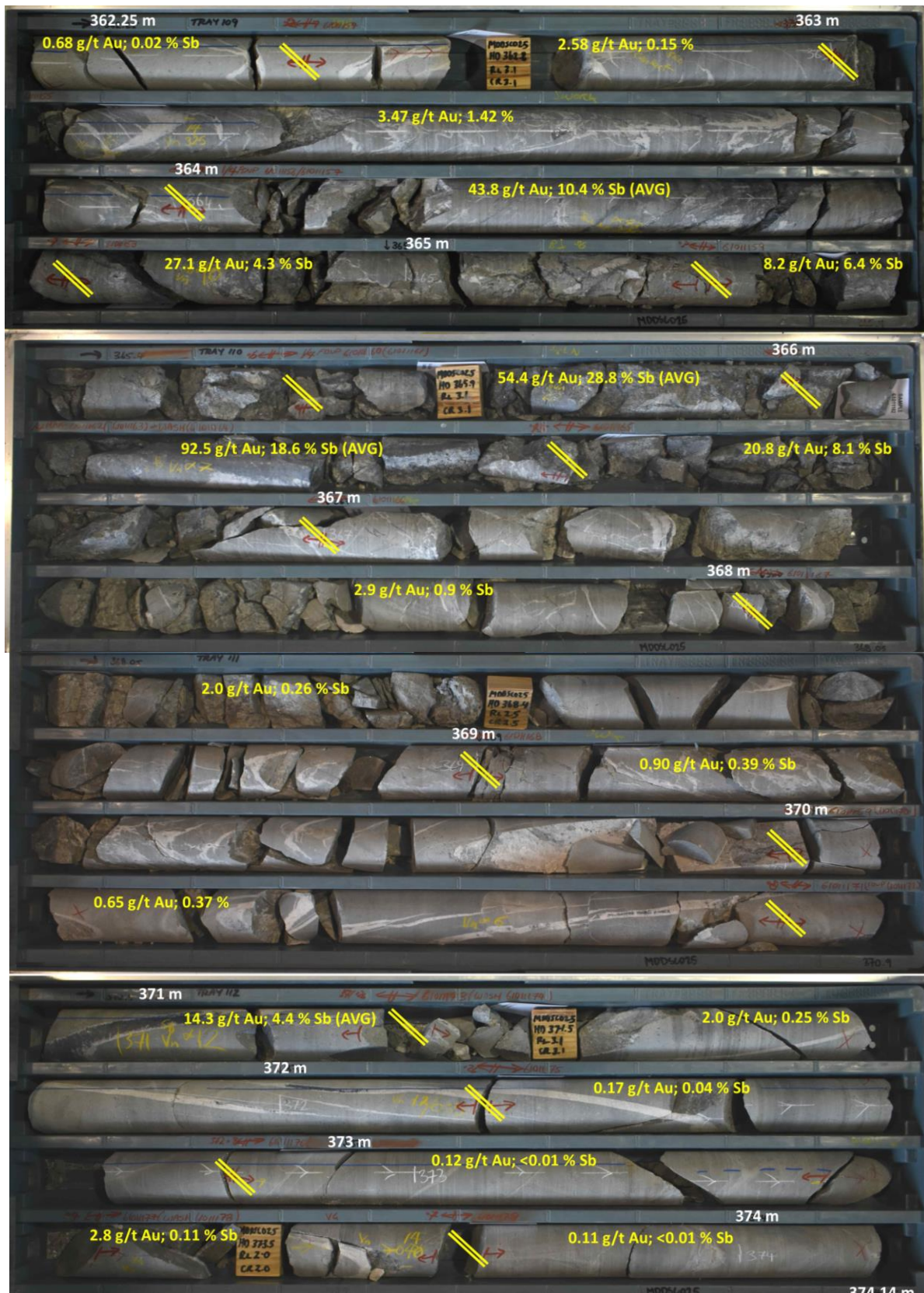
Abbildung 3: kommentierter HQ-Bohrkern (63,5 mm Durchmesser) mit Angabe der Bohrlochtiefe und des Goldgehalts von MDDSC0025: 11,7 Meter mit 12,4 g/t Au und 3,6 % Sb (16,0 g/t AuÄq) ab 362,0 Meter in Bohrung MDDSC0025, einschließlich 3. 0 Meter mit 41,4 g/t Au und 12,0 % Sb (53,4 g/t AuÄq) ab 364,0 Meter oder 6,5 Meter mit 20,6 g/t Au und 6,0 % Sb (26,6 g/t AuÄq) ab 362,5 Meter und 0,5 Meter mit 14,3 g/t Au und 4,4 % Sb (18,7 g/t AuÄq) ab 370,8 Meter.
