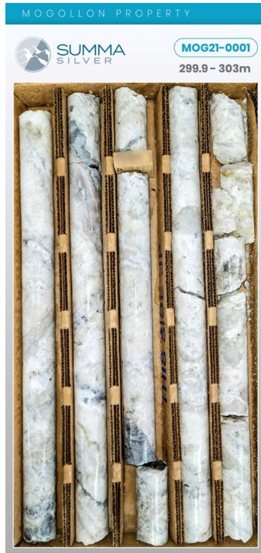
Abbildung 2: Bohrkernfoto, das epithermal-verwandte Quarzgangtexturen in MOG21-01 auf 299,9 Metern zeigt
