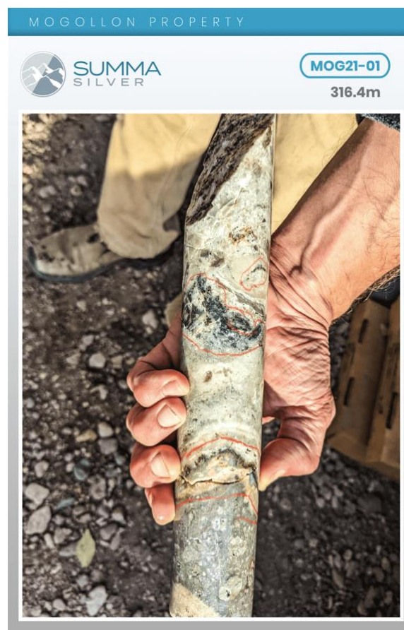
Abbildung 1: Beispiel eines mineralisierten Kerns aus der Ader Queen. Gebänderter und brekziöser Quarzgang mit geronnenen und gebänderten Silbersulfiden (rot eingekreist).
