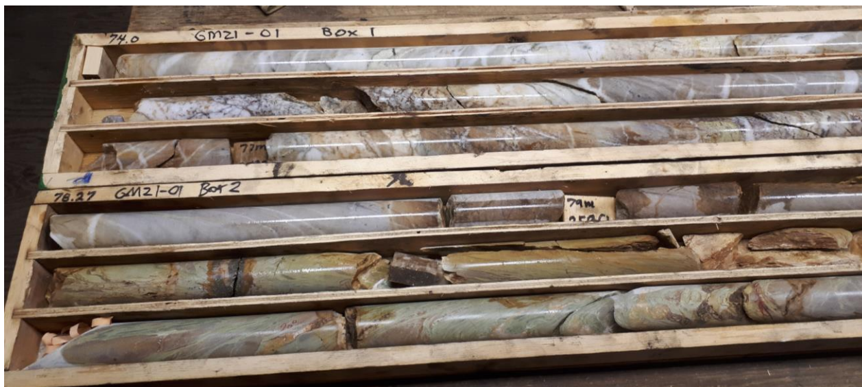
Foto des Bohrkerns aus Bohrloch GM21-01 mit typischen Quarzerzschnüren in Serizit und Eisenkarbonat-alteriertem Sedimentgestein und damit verbundener Pyritmineralisierung (teilweise oxidiert).
