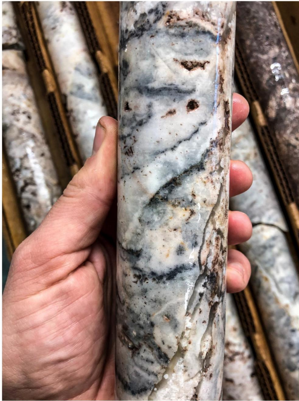
Abbildung 1: Beispiel eines mineralisierten Kerns aus der Ader Queen in MOG22-04 auf 351 m. Gebänderter und brekziöser Quarzgang mit vereinzelt und gebänderten Silbersulfiden.
