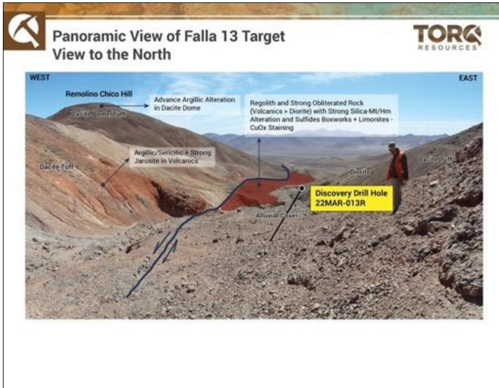
Abbildung 3: Zeigt einen Blick in Richtung Norden auf den Strukturkorridor Falla 13. Die Oberflächenausprägung der Mineralisierung, die in Bohrloch 22MAR-013R angetroffen wurde, wird durch eine starke Siliziumdioxid-Hämatit-Alteration mit Sulfid-Boxwork, Limonit und Kupferoxid-Färbung entlang von Brüchen dargestellt.
