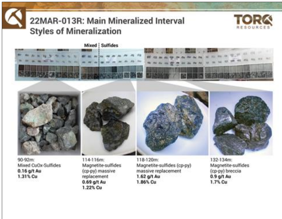
Abbildung 7: Veranschaulicht die gemischte Oxid-/Sulfid- und reine Sulfid-Mineralisierung, die in den RC-Chips beobachtet wurde und reichlich Chalkopyrit und Pyrit aufweist.
