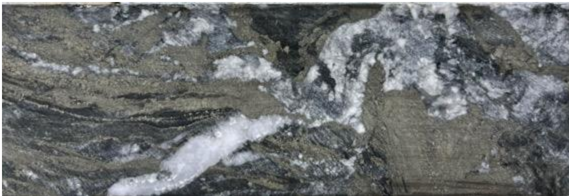
Bild 1: Halbmassiver Pyrit im Eagle-Telbel-Stil mit unregelmäßigen und aufgebrochenen Eisencarbonat-Adern aus 346,5 m in EM-22-005, Teil einer 1-m-Probe mit einem Gehalt von 1,2 g/t Au.
