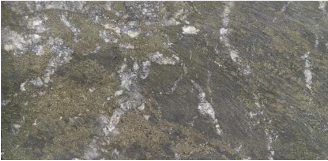
Bild 2: Halbmassiver Pyrit vom Typ Eagle-Telbel mit wenigen Eisencarbonat-Adern aus 352,3 m in EM-22-005, Teil einer 1-m-Probe mit einem Gehalt von 7,6 g/t Au.
