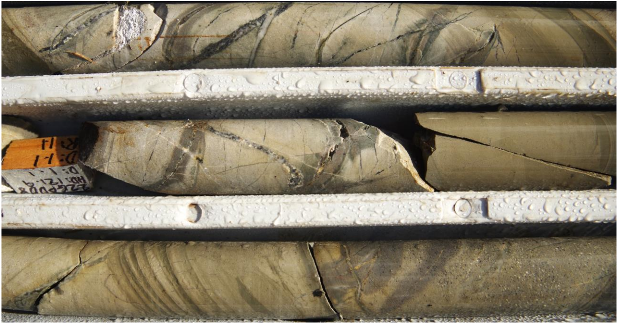
Abbildung 5: Diamantbohrkern aus Great Pyramid (22GPDD008, 123 m). Wechsellagernder Sandstein und Schluffstein mit mehrphasigen Quarz-Sulfid-Gängen (bei Sulfiden dominieren Arsenopyrit-Pyrrhotin-Pyrit) in Verbindung mit Biotit-, Chlorit- und Serizit-Alteration. Diamantkernbohrung unterhalb des historischen Ressourcengebiets, Analyseergebnisse stehen noch aus.
