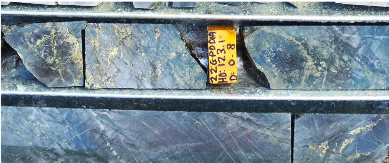
Abbildung 6: Diamantbohrkern aus Great Pyramid (22GPDD001A, 123,1 m). Starke Chlorit-Quarz-Alteration mit reichlich Pyrrhotin-Chalkopyrit-Pyrit-Magnetit-Gängen und Brekzien. Diamantkernbohrung unterhalb des historischen Ressourcengebiets, Analyseergebnisse stehen noch aus.
