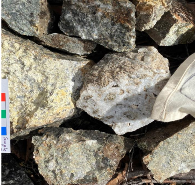
Abbildung 3. Probe GM10067 zeigt einen stark greisenalterierten, quarzgeäderten und brekziösen Granit aus einem noch nicht anhand von Bohrungen erkundeten Bereich der historischen Abbaustätten, der auf einer Fläche von mehr als 1 x 0,5 km kartiert wurde. Probe GM10067 wies einen Zinngehalt von 2,1 % auf, sieben weitere Proben aus dem Gebiet lieferten Zinnwerte von über 0,1 %. Farbskala in cm.
