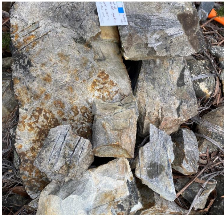
Abbildung 4. Probe GM10070 zeigt eine feine Quarz-Turmalin-Kassiterit-Aderung im quarz-serizit-alterierten Sandstein der Mathinna Supergroup. Probe GM10070 wies einen Zinngehalt von 0,52 % auf und stammt aus einem noch nicht bebohrten Bereich der historischen Abbaustätten von rund 600 x 150 m Ausdehnung. Farbskala in cm.
