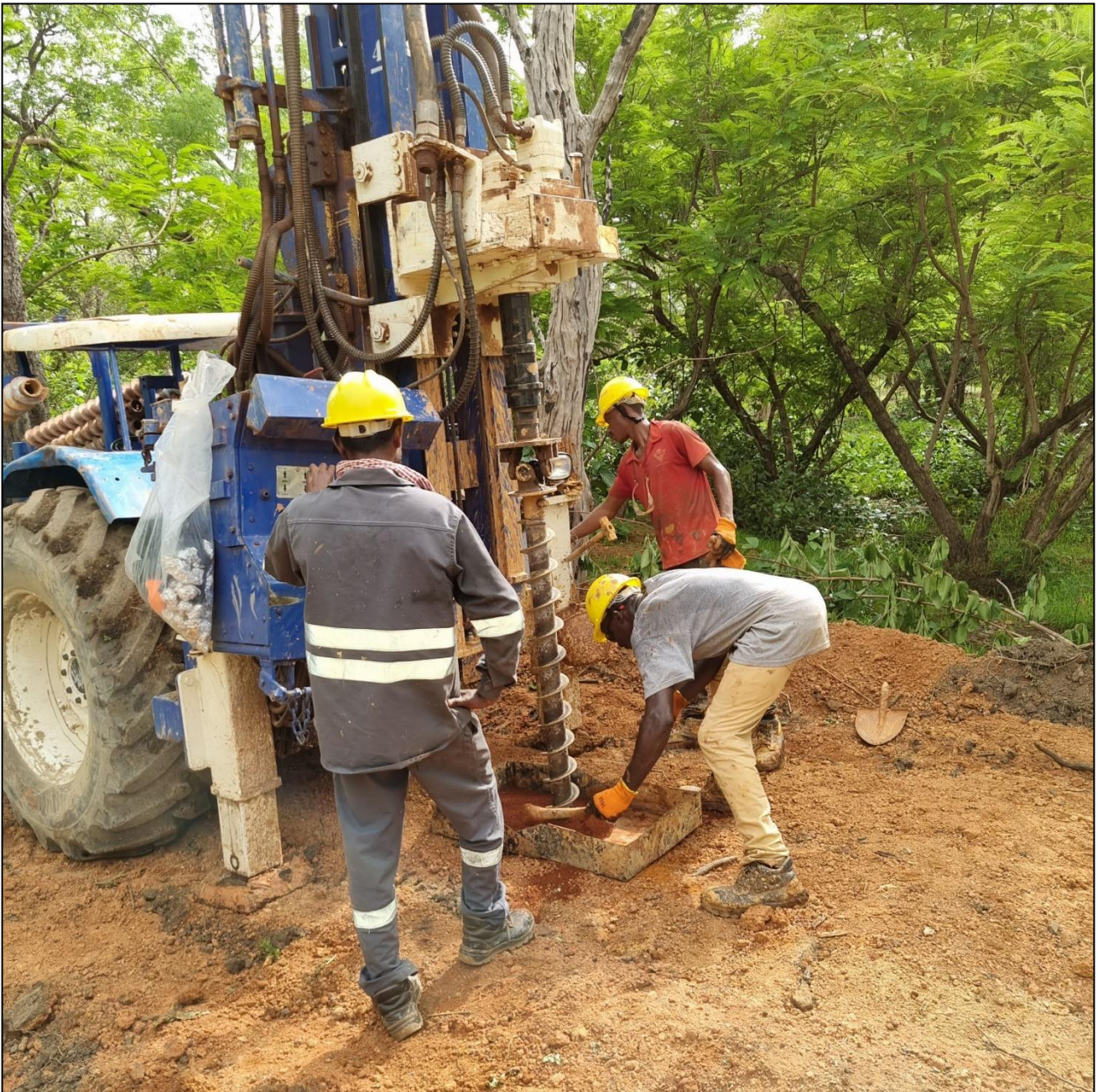
Abbildung 4: Ergänzende Schneckenbohrungen im Goldprojekt Kada im Prospektionsgebiet Bereko, 7 km nördlich der rund 930.000 Unzen umfassenden Mineralressourcenzone im Prospektionsgebiet Massan.
