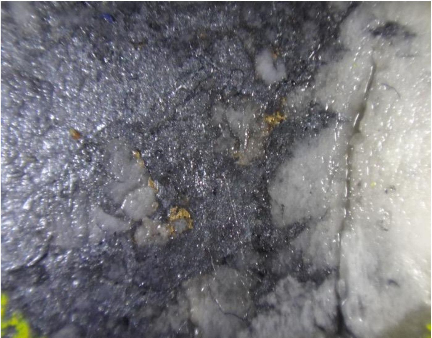
Foto 3: SDDSC039 @ 203,7 m: Ferroanischer Dolomit und Quarz mit Stibnit und sichtbarem Gold. Ein Abschnitt von durchschnittlich 0,5 m mit 82,6 g/t AuEq (42,9 g/t Au und 25,1 % Sb) auf 203,7 m. Das Sichtfeld des oberen Bildes beträgt 15 mm.
