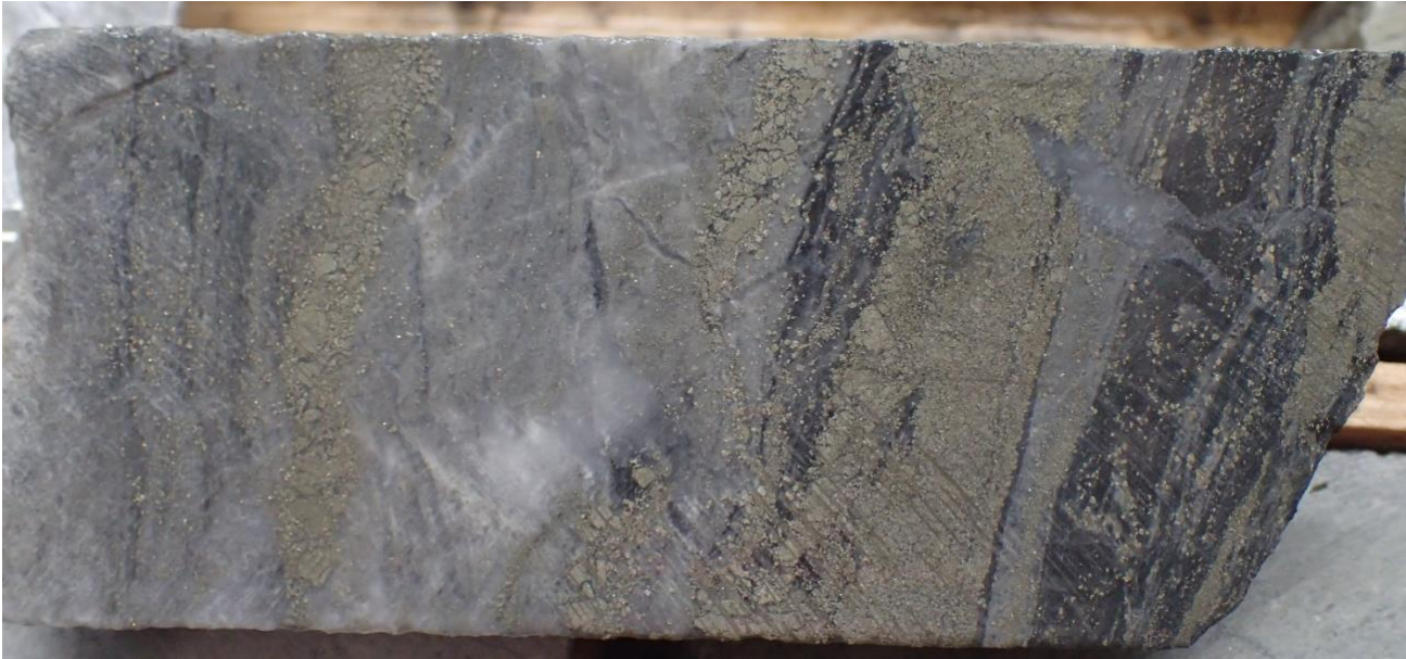
Platte 2: Mineralisierter Abschnitt innerhalb der Probe von 992-993 m mit einem Gehalt von 24,4 g/t Au in einem Gemisch aus alteriertem Mikrogabbro (linke Seite) und Sediment (rechte Seite).
