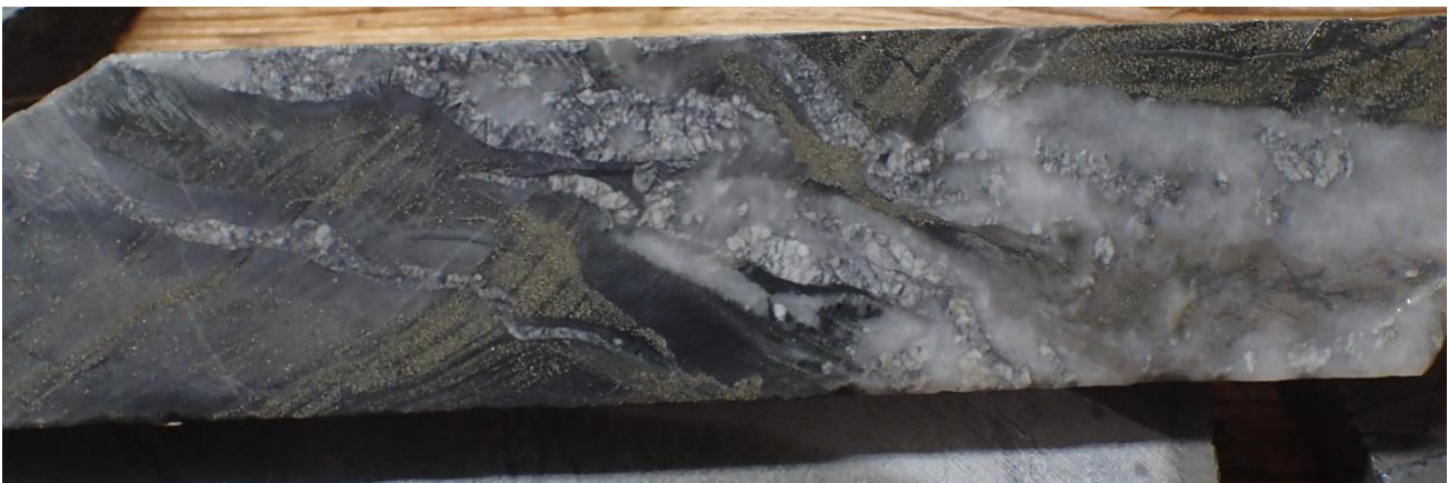
Platte 1: Bohrkern aus EM-22-009 bei 991,3 m; Sedimentabschnitt innerhalb der Mikrogabbro-Einheit, in einem 1-m-Abschnitt mit einem Gehalt von 6,66 g/t Au. Man beachte die Quarz-Ankerit-Adern, die die Sulfidbänder durchschneiden. Optisch ähnelt er der in der Vergangenheit abgebauten Mineralisierung, befindet sich jedoch deutlich nördlich des Haupthorizonts der Mine Eagle.
