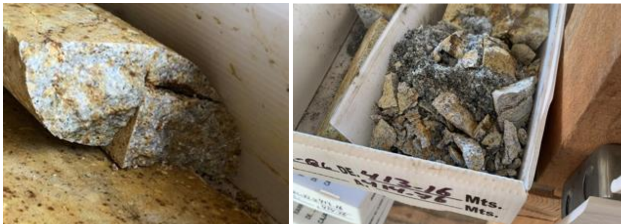
Abbildung 3- Aufgebrochener Kern nach 5 - 6 Monaten Abbildung 2 Anderer Kern nach 5 bis 6 Monaten
