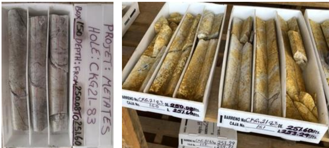
Abbildung 1 - Frischer Kern aus der Bohrung 2021 Abbildung 2 - Derselbe Kern 5 bis 6 Monate später
