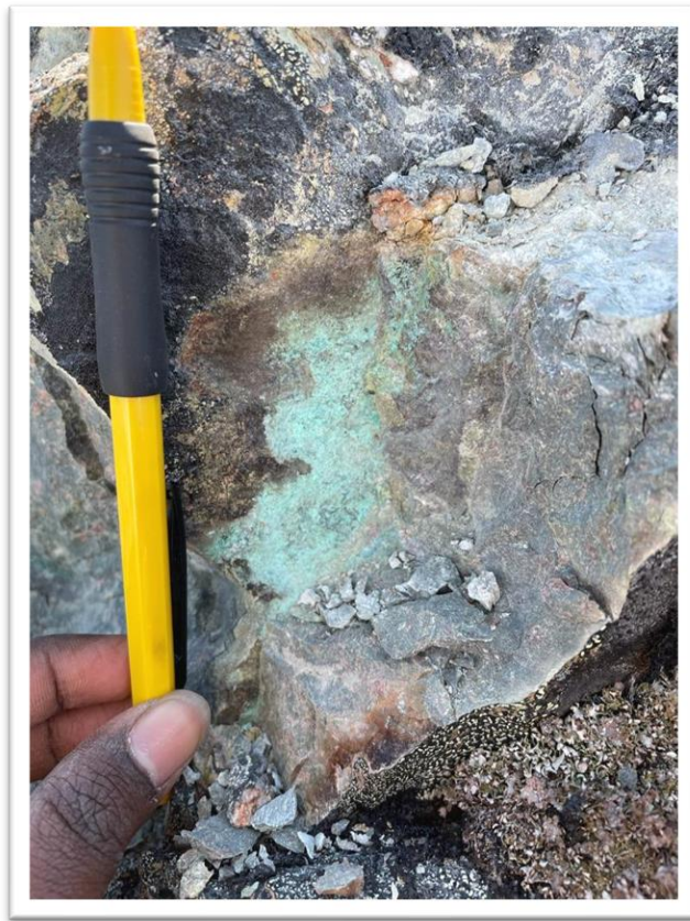
Abbildung 4: Probe 22-NM-041C. Malachit in Feldspatporphyr auf dem LUR Moran Lake Trend.
