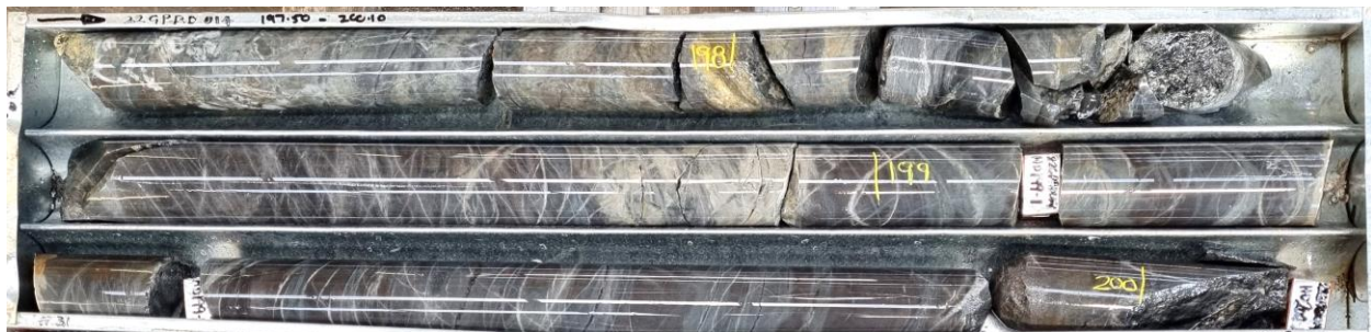
Abbildung 3: Diamantbohrkern aus Great Pyramid (22GPRC014 197,5-200,10 m), unterhalb des historischen Ressourcengebiets, Analyseergebnisse stehen noch aus. Intensive, lagige Quarz-Karbonat \pm Sulfid-Gangbildung in stark verkieselten, mittel- bis grobkörnigen Sandsteinen. Historische Explorationsarbeiten deuten darauf hin, dass Gänge dieser Art Kassiterit enthalten und typisch für die mineralisierten Zonen sind.
