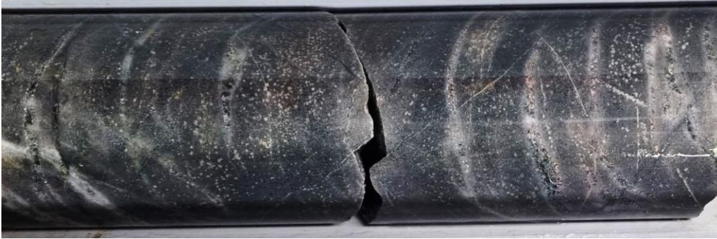
Abbildung 4: Diamantbohrkern aus Great Pyramid (22GPRC006 205,2 - 205,35 m), unterhalb des historischen Ressourcengebiets. Feinlagige Quarz-Karbonat-Cassiterit-Gänge in stark verkieseltem Sandstein. Die Analyse eines 1 Meter langen Abschnitts aus 205,0-206,0 m Bohrtiefe lieferte 0,54 % Zinn.
