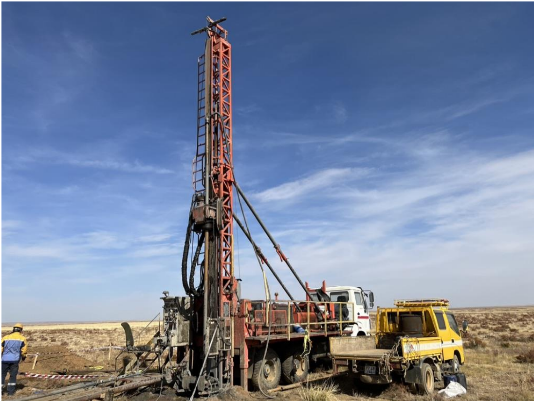
Abbildung 4. Diamantkernbohrungen bei UNDH-02.
