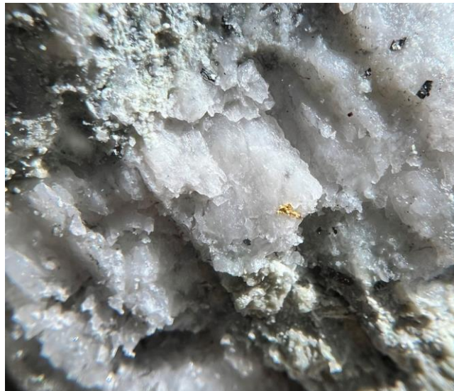
Foto 3: SDDSC049 212,4 m, Sichtfeld 60 mm, zeigt sichtbares Gold in gelben Kreisen innerhalb einer Quarz-, Karbonat- und Stibnit-Ader mit einem alterierten dioritischen Gang am Rand der Ader.
