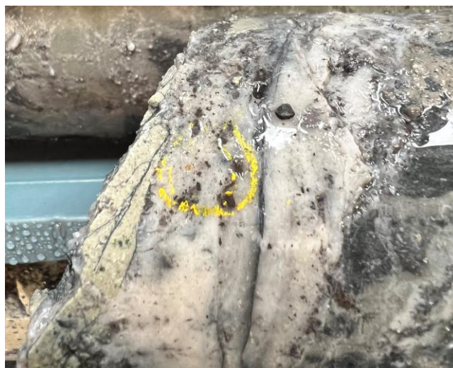
Foto 3: SDDSC049 212,4 m, Sichtfeld 60 mm, zeigt sichtbares Gold in gelben Kreisen innerhalb einer Quarz-, Karbonat- und Stibnit-Ader mit einem alterierten dioritischen Gang am Rand der Ader.
