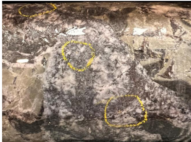
Foto 2: SDDSC049 211,9 m, Sichtfeld 20 mm, mit sichtbarem Gold im Quarz.
