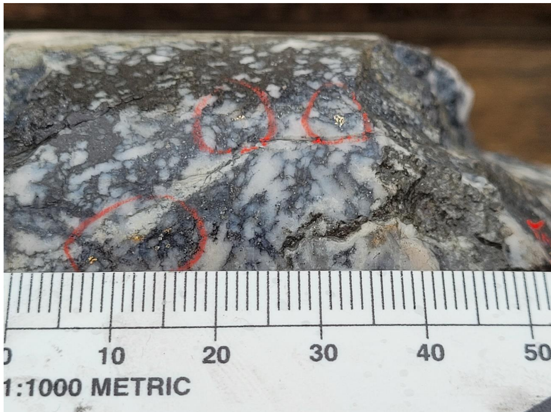
Foto 4: SDDSC050 623,7 m, mit sichtbarem Gold im Quarz. Maßstabsbalken in mm.
