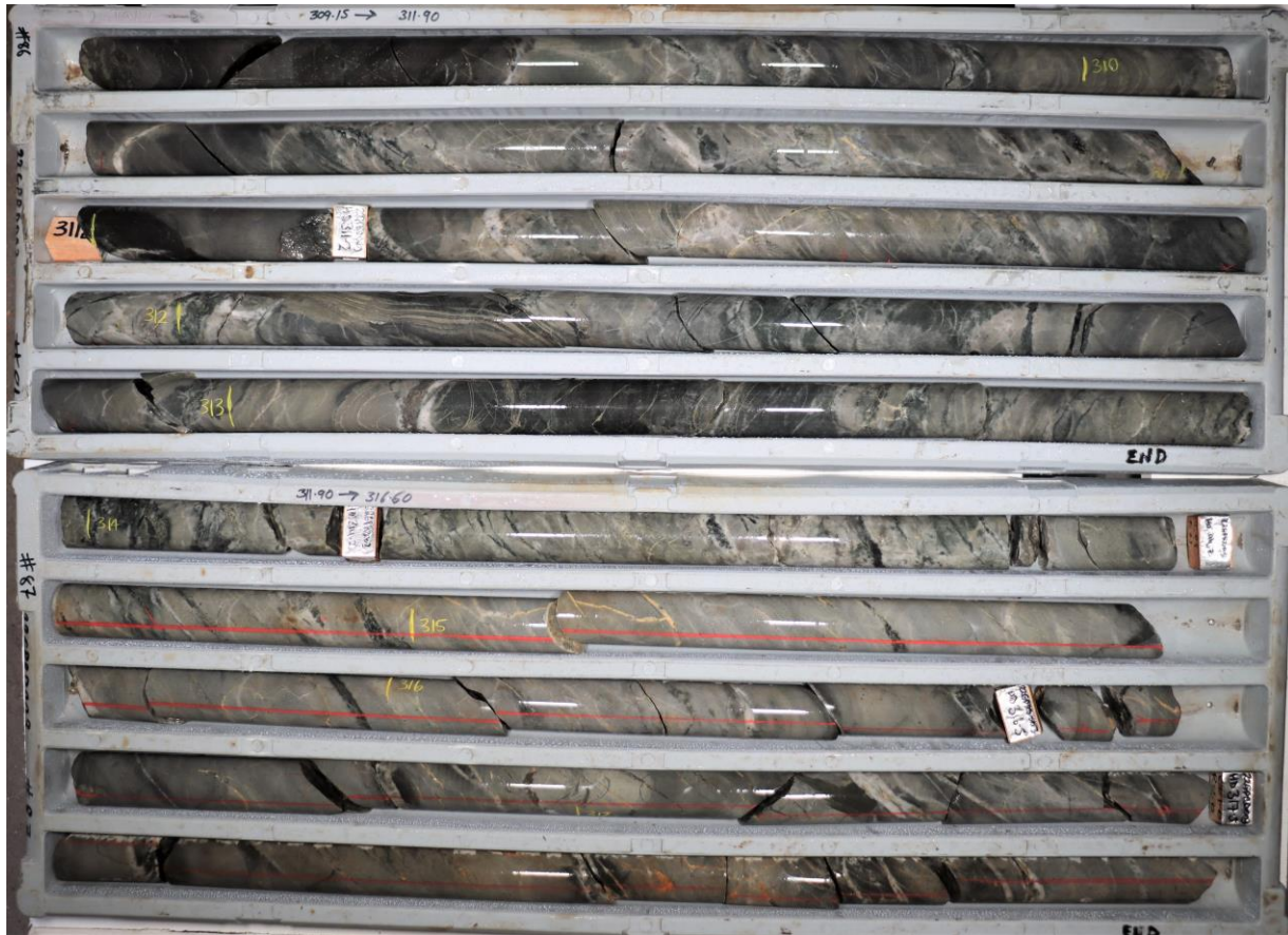
Abbildung 3: Diamantbohrkern aus Great Pyramid (22GPRC003, 309,15-316,60 m), unterhalb des historischen Ressourcengebiets. Der Abschnitt von 308,0 bis 326,0 m enthielt 0,31 % Sn. Der Abschnitt von 313,0 bis 315,0 m hatte einen Gehalt von 0,96 % Sn. Intensiv geschichtete und erzstockartige Quarz-Karbonat-Kassiterit-Gänge in verkieselten, mittel- bis grobkörnigen Sandsteinen und wechsellagernden Schluffsteinen.
